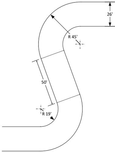
**DIAGRAM A-1.12: HAMMERHEAD TURNAROUND DETAIL**
